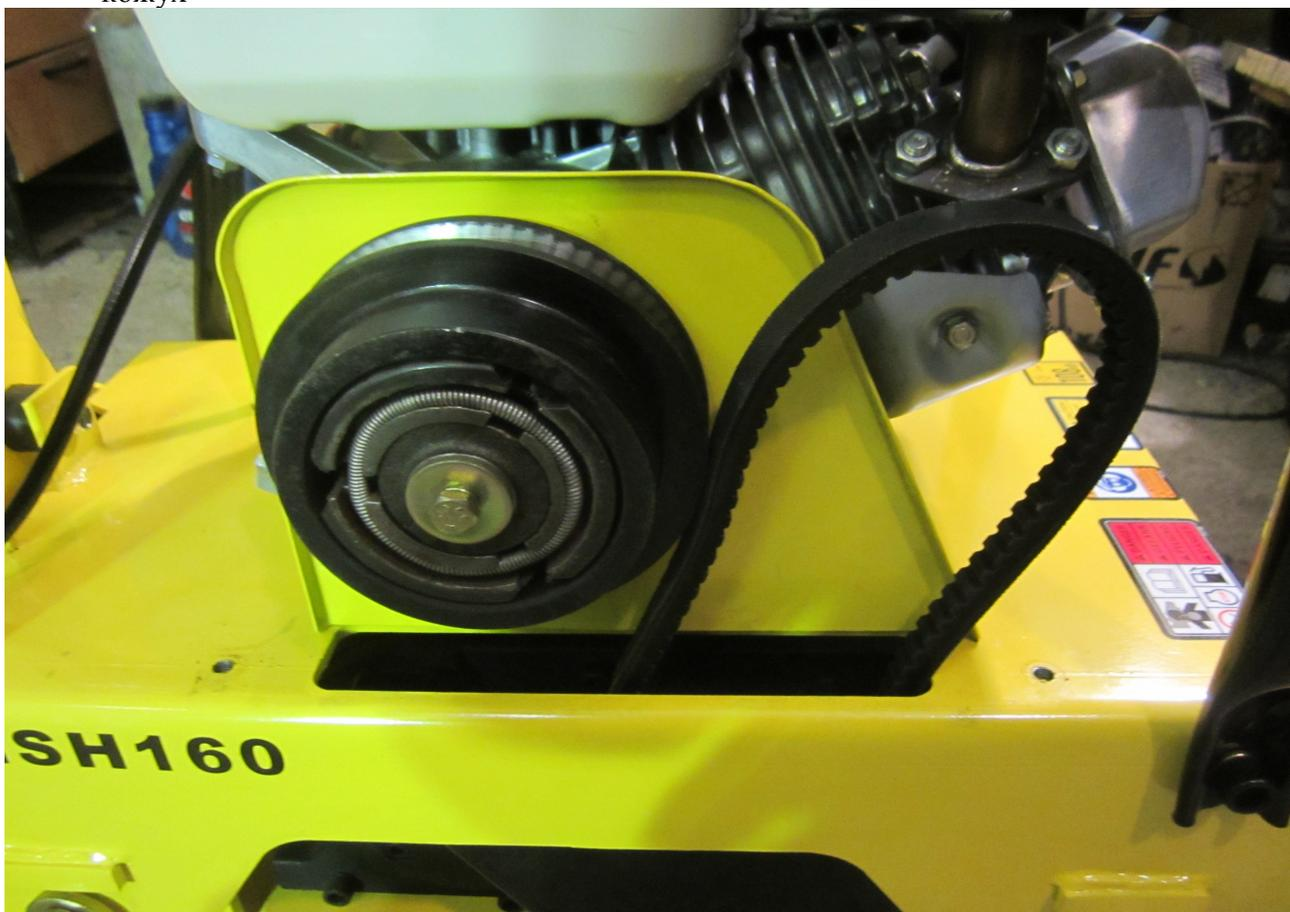
3. Снимаем приводной ремень со шкива и отводим его в сторону как показано на фото
