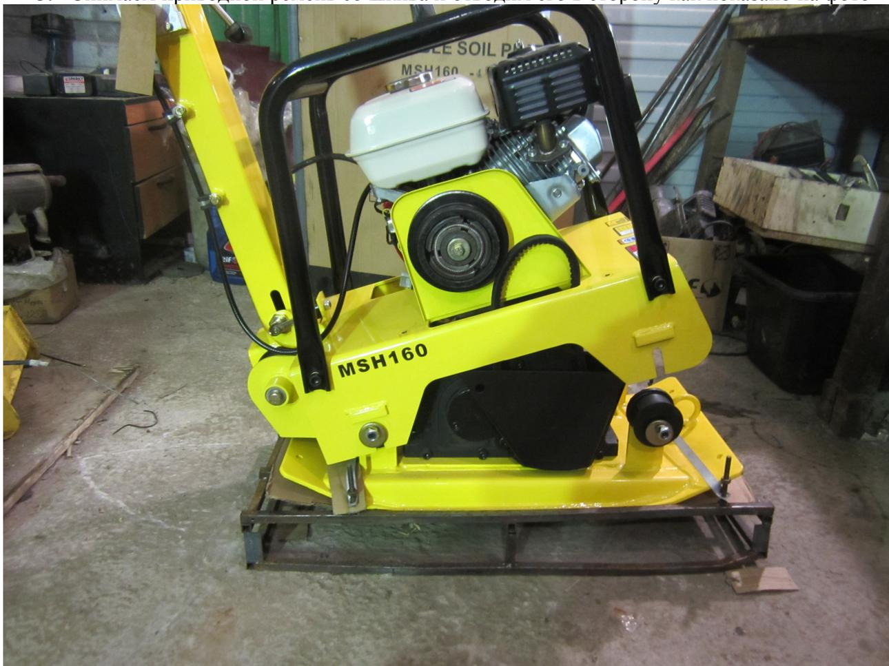
4. Поднимаем переднюю часть установочной плиты как показано на фото и фиксируем ее.
