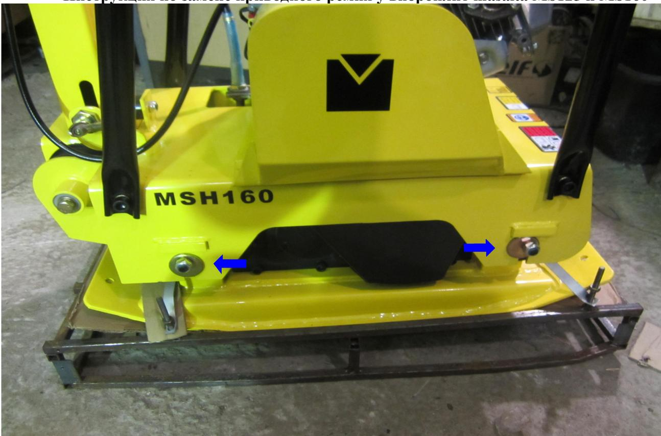
1. Ключом на 19 откручиваем четыре болта крепления основания виброплиты и снимаем эксцентрики
