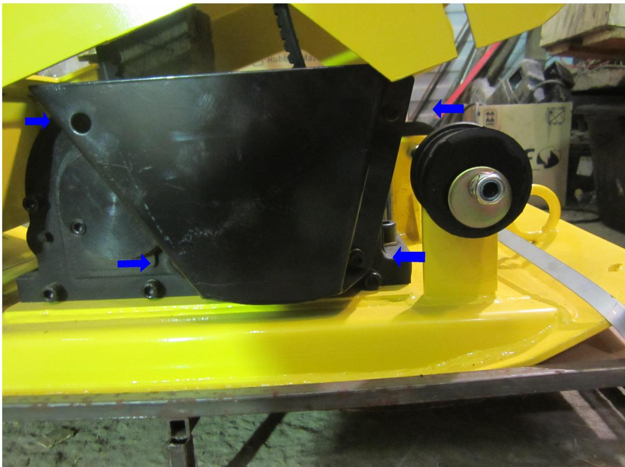
5. Откручиваем шестигранником 5.5.мм четыре винта крепления нижнего кожуха приводного ремня, снимаем кожух и извлекаем ремень
