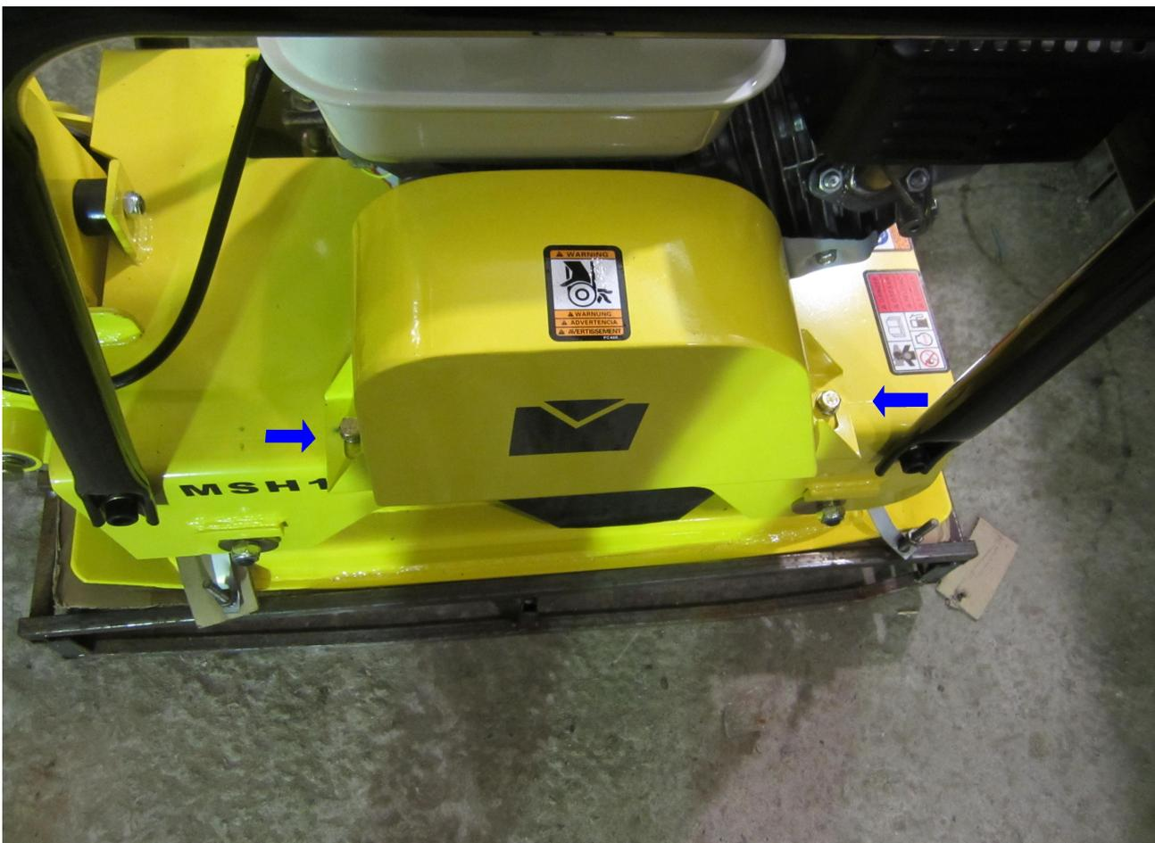
2. Ключом на 13 откручиваем два болта крепления верхнего кожуха приводного ремня и снимаем кожух
