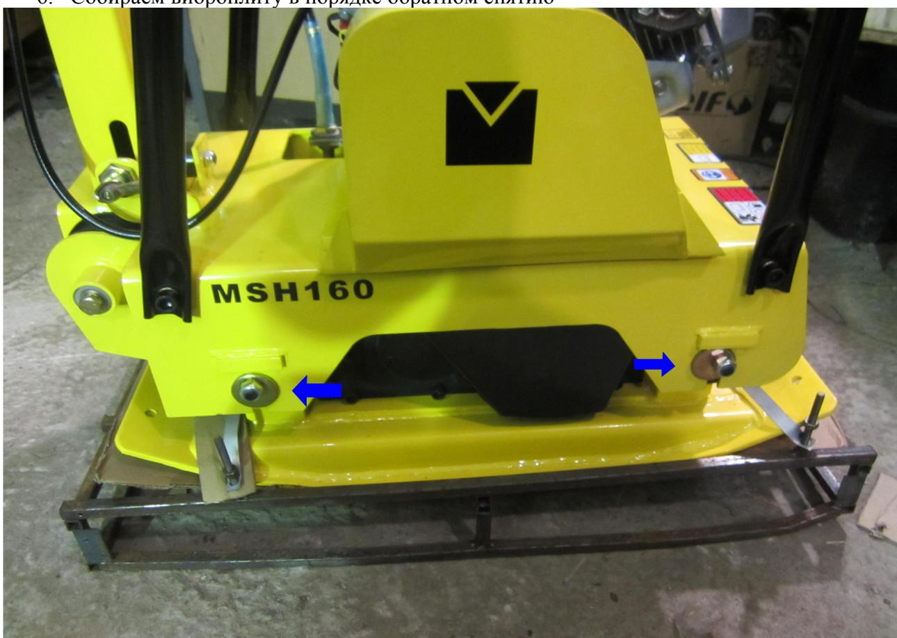
7. Натяжение ремня регулируется эксцентриками на основании виброплиты.
