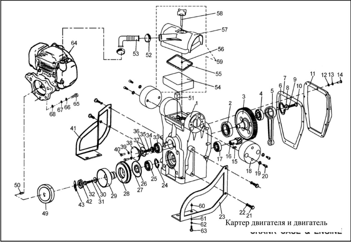
Картер двигателя и двигатель
